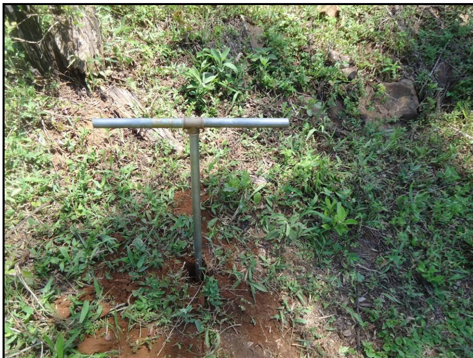
Figura 59 – Execução da sondagem ST-06.
