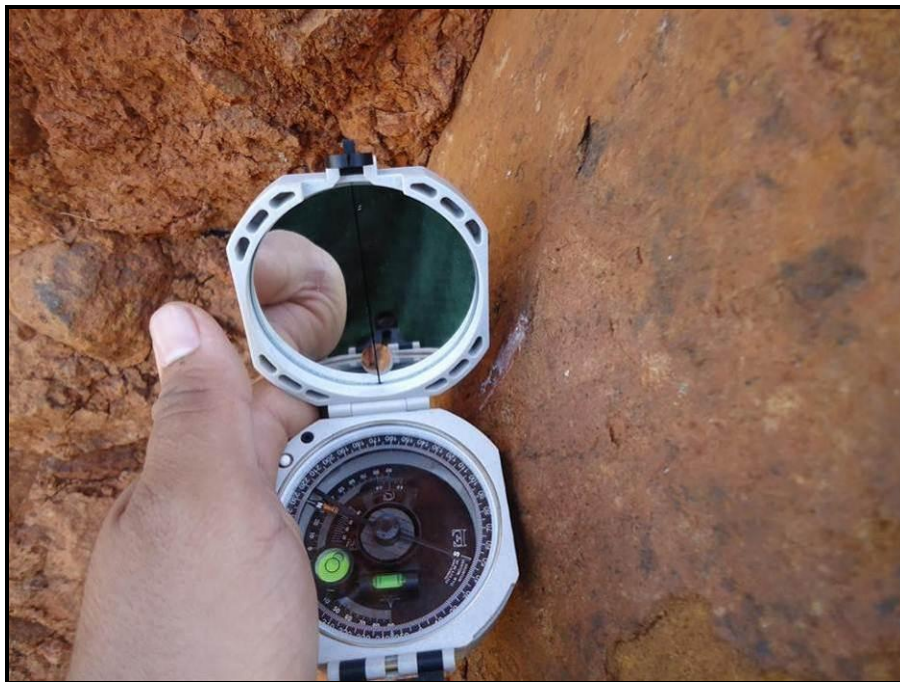
Figura 69 – Tomada de direção e ângulo de mergulho com a bússola de geólogo em afloramento rochoso.
