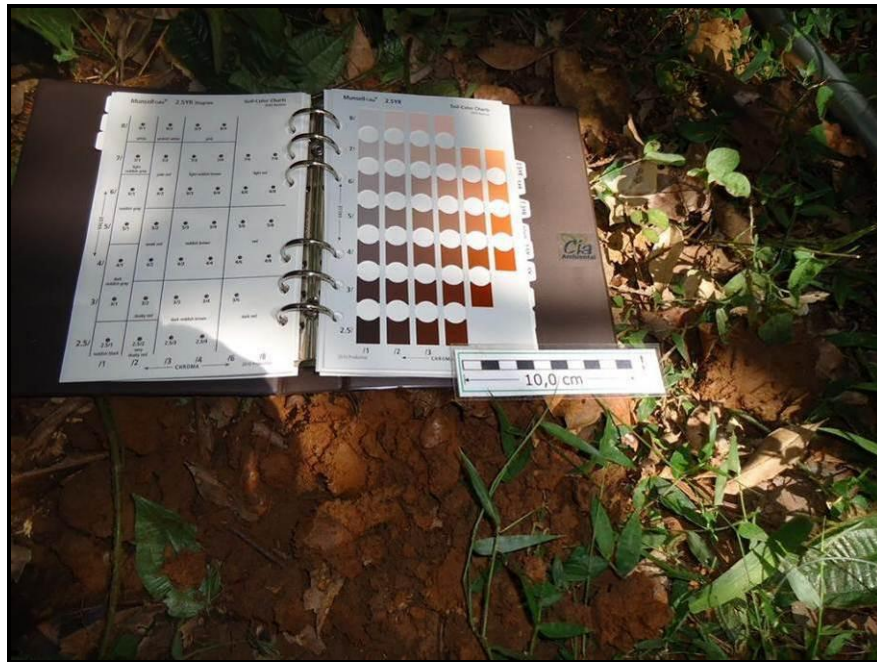
Figura 49 – Identificação da cor com a carta de solos de Munsell.
