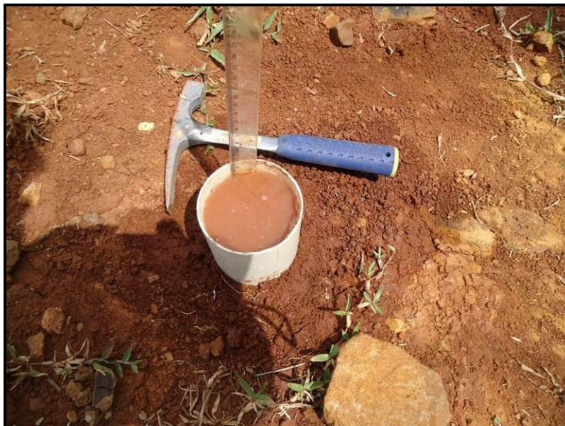
Figura 70 – Registro fotográfico do ensaio de infiltração realizado.
